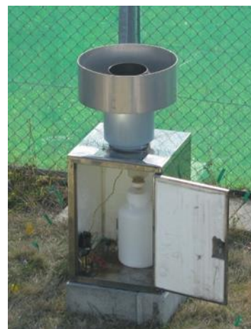
屋外に設置した沈着サンプラー
