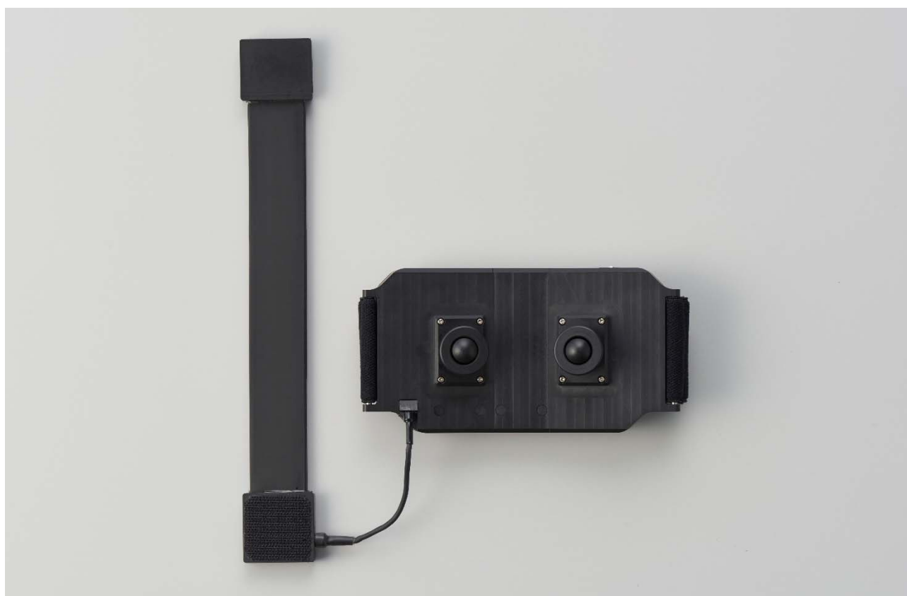
図3 ウェアに内蔵したセンサユニット（左が加速度センサ，曲げセンサ，右突起部2つが筋硬さセンサ）
